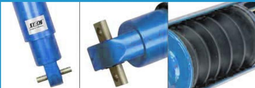
Estos amortiguadores se usan para el amortiguamiento de los movimientos ondulados del bastidor, así como amortiguadores entre vagones.
